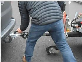
On peut donc décrocher la machine en toute sécurité et sans effort en mettant la roue jockey au sol et en relevant l'attelage grâce au réglage en hauteur possible avec la crémaillère, même sur terrain en pente, la machine est immobile.
