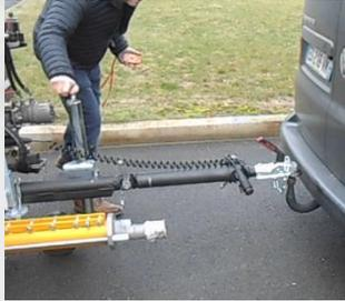
En fin de chantier, la machine peut aller se positionner précisément au-dessus de la tête d'attelage du véhicule tracteur, il suffit alors de faire descendre le timon avec la crémaillère de la roue jockey pour procéder au verrouillage automatique sans aucune autre action humaine.
