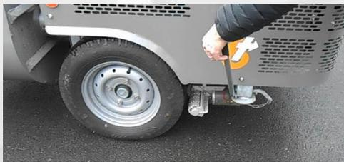
En arrivant sur le chantier, quand le véhicule tracteur est à l'arrêt, il suffit de mettre en contact les deux galets sur les roues, la machine est alors immobilisée car les deux galets font office de frein.
