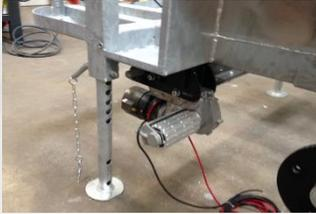
Le système de transmission débrayable est constitué de deux rouleaux à friction (galets) entraînés par deux puissants moteurs électriques 12 Volts positionnés sur chaque roue de l'essieu, les moteurs sont commandés par une radiocommande.
