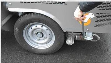
Après vérification du verrouillage de l'attelage, de la mise en place de la chaîne de sécurité et du cordon d'alimentation des feux, on peut libérer les galets des roues pour que la machine puisse être tractée.
